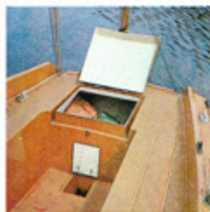
Geräumige Achterpiek und Lenzschute im Cockpit
